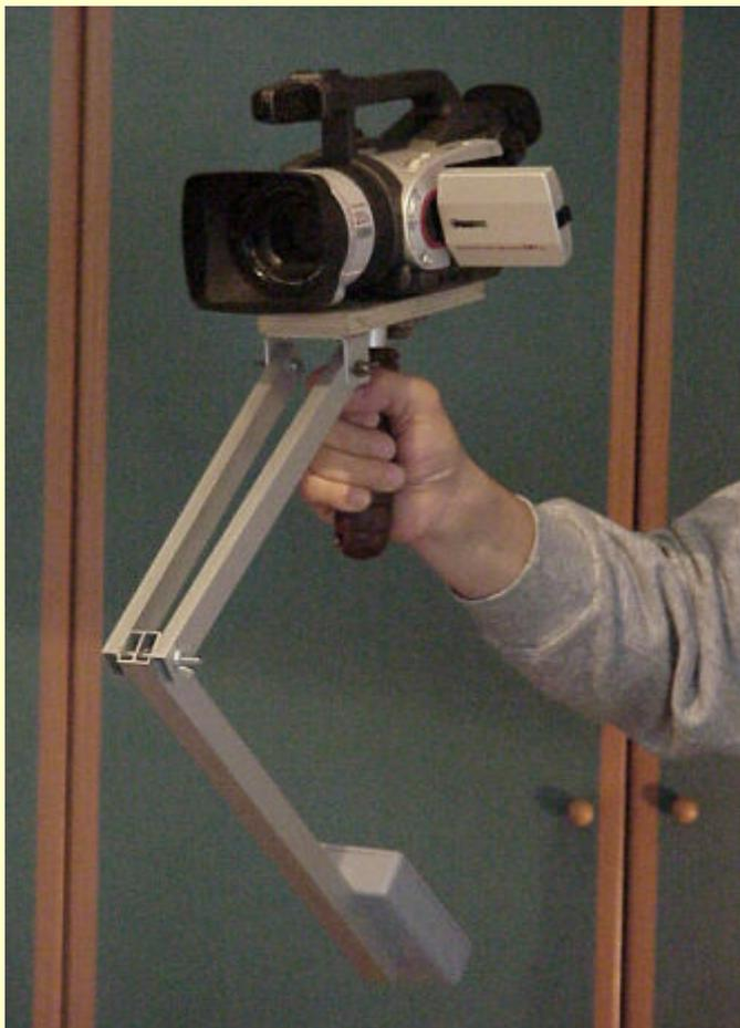
Questa è una versione casalinga delle steadycam JR che si trovano in commercio per telecamere DV. Oltre al risparmio, il modello proposto ha il vantaggio che si può piegare in fase di trasporto con un ingombro ridotto. Il prototipo costruito funziona ottimamente.
