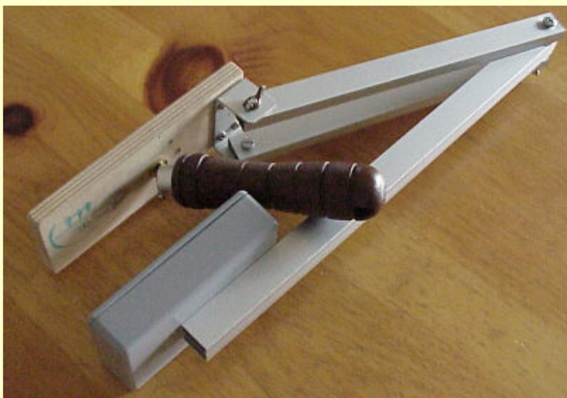
6. Montare la telecamera. Regolare la posizione in modo che la base non blocchi i controlli o l'ottica. Con la telecamera montata, modificare l'angolo degli snodi del braccio in modo da ottenere l'assetto giusto. Eventualmente si può aumentare o diminuire il contrappeso.
