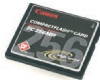
**In alto:** Le schede CompactFlash sono estremamente compatte, circa 42 x 36 mm. La figura illustra le dimensioni reali di una scheda. Le schede Type II hanno uno spessore leggermente superiore a quello delle schede Type I. Negli alloggiamenti Type I possono essere utilizzate solo schede Type I, mentre entrambi i tipi di schede possono essere utilizzati negli alloggiamenti Type II.
